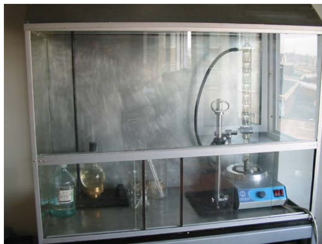
Рис.2.2.р.1 Стенд определения степени сшивки
