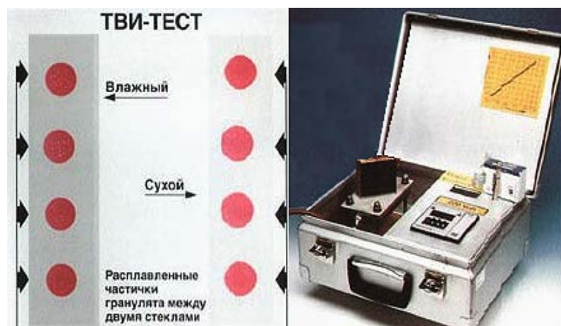
Рис.2.4.3.п.2 TVI-влажномер
